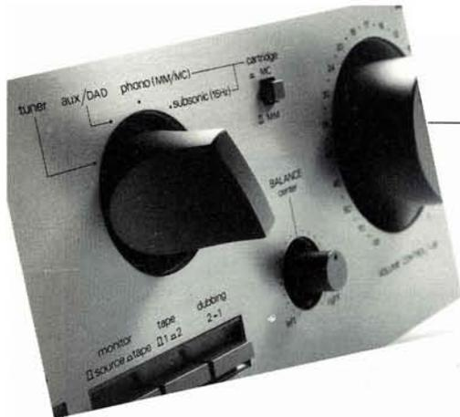
l'ottimizzazione dell'interfacciamento con la testina. Vi sono due ingressi ad alto livello: uno è il tuner, l'altro è denominato aux/DAD. Inoltre si possono collegare i classici due registratori con possibilità di effettuare riversamenti incrociati. I controlli di tono hanno giustamente un'escursione limitata (entro  $\pm 8$  dB) e sono escludibili con il tasto *defeat*.
